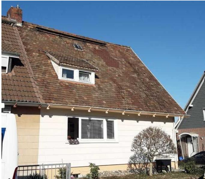
Doppelhaushälfte Finnhaus mit wenig Veränderungen, das untere Fenster wurde verbreitert. Typische winzige Schleppgaube und ganz oben unter dem First eine alte unterteilte Dachluke.
